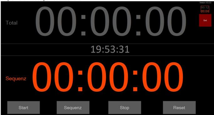
Wenn die Uhr zurückgesetzt ist, können beide Uhren mit einem touch gestartet werden. Jeder weitere touch setzt die Sequenz zurück.
